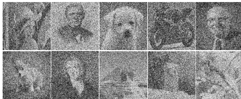
Hình 3.6: 10 ảnh xám được sử dụng để nhận dạng với nhiễu Gauss có SNR là -10 dB.
